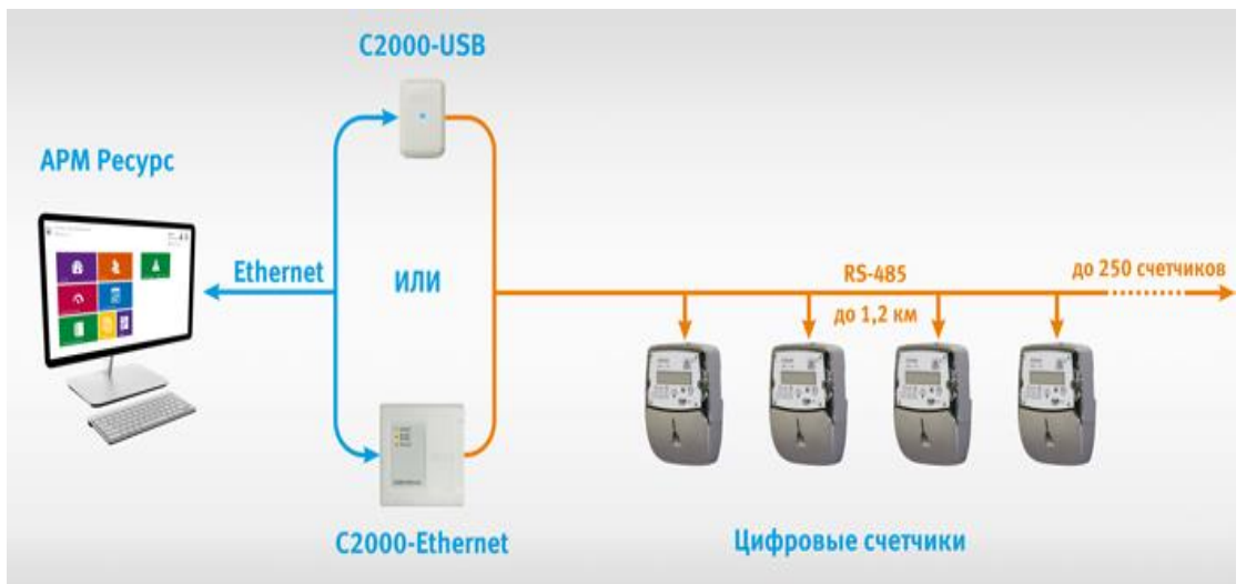
Рисунок 2.15 – Структурная схема канала для цифровых счетчиков
