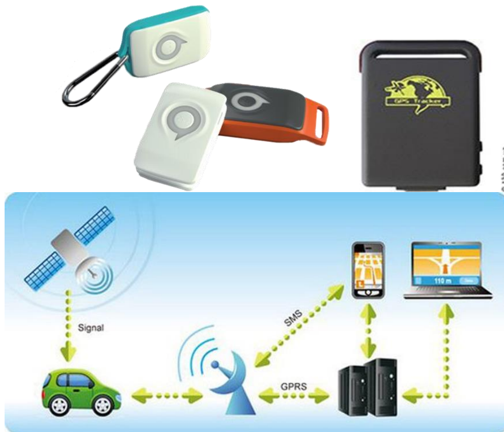
Рисунок 2.10 – GPS трекер и принцип его работы
