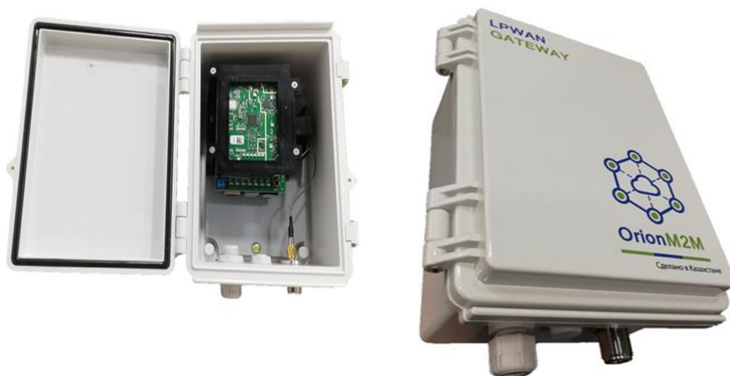
Рисунок 2.5 – Базовая станция ORION gateway
