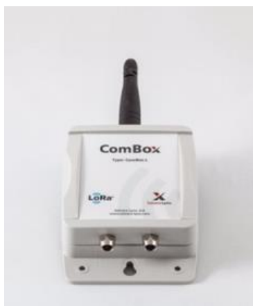
Рисунок 2.9 – Температурный сенсор с аналоговыми входами
